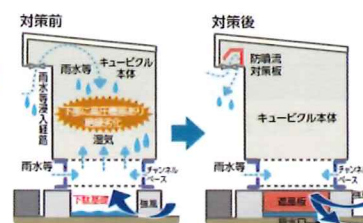
キュービクルの雨水等浸入対策
